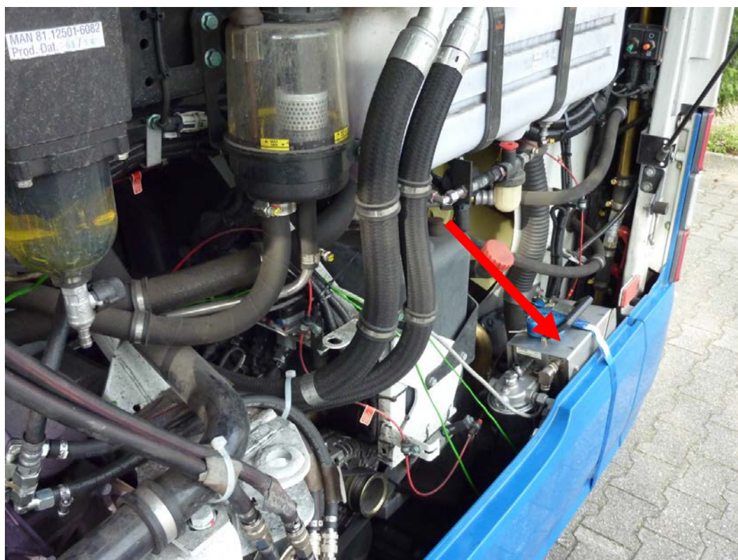
Abbildung 16: Anbringung des Kraftstoffverbrauchsmesssystems im Fahrzeug
