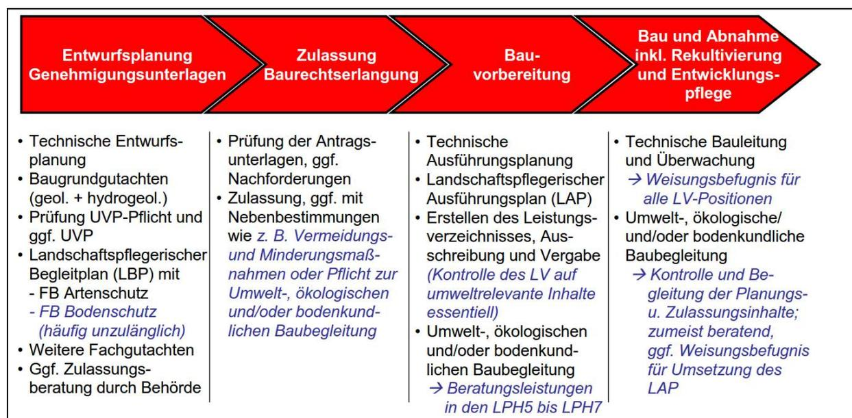
**Abb. 3–1:** Bodenschutz in den unterschiedlichen Phasen eines Bauvorhabens
