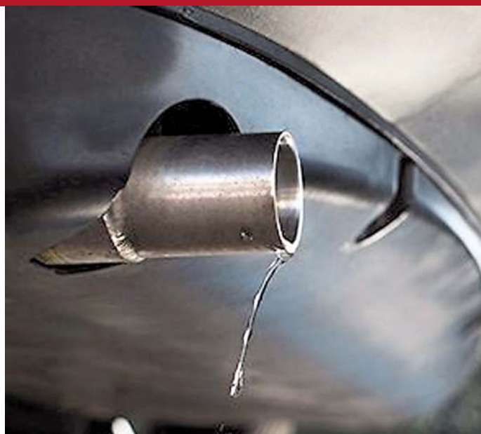
Aus dem Auspuff von Wasserstoff-Autos kommen keine Abgase, sondern reiner Wasserdampf.
