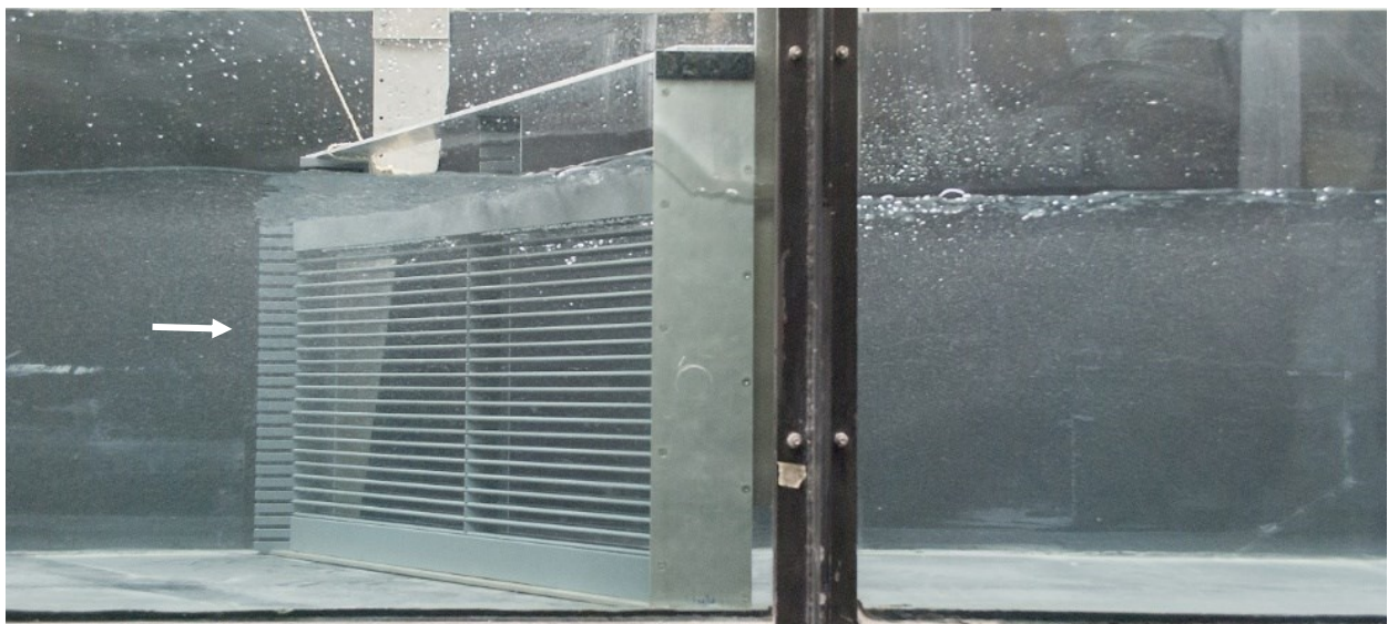
Abb. 2: Horizontaler Fischleitrechen im Laborversuch ( \alpha = 45^\circ , b = 0.01 m, l = 0.025 m, Sohl- und Tauchleitwand mit Verbauungsgraden von jeweils 10 % der Rechenfläche) (Maager, 2016)
