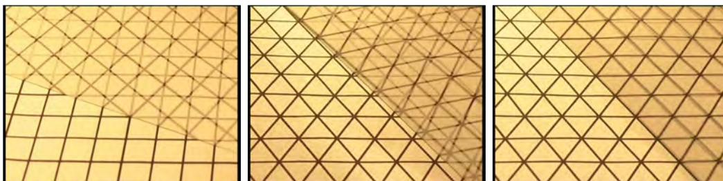
Abbildung 7.10: Links: In einem Muster aus Parallelogrammen im Winkel 80 Grad gibt es keine Symmetrieachse. Ein semitransparenter Spiegel wird in keiner Stellung Übereinstimmung zwischen Original und Spiegelbild anzeigen. Rechts: In einem Muster aus gleichseitigen Dreiecken im Winkel 60 Grad gibt es sechs Symmetrieachsen. Ein semitransparenter Spiegel wird genau in diesen Stellungen Übereinstimmung zwischen Original und Spiegelbild anzeigen, sonst nicht.
