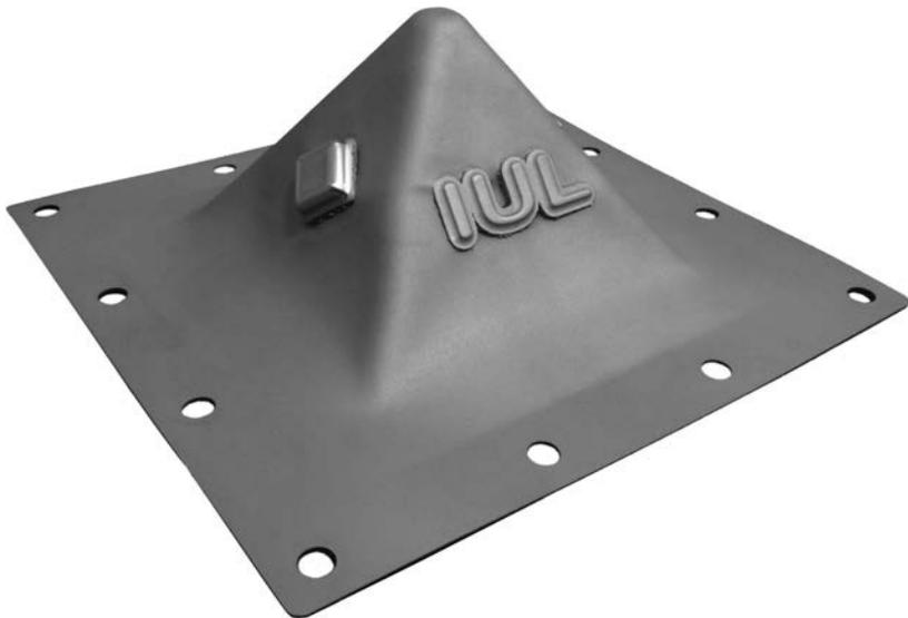
Inkrementell umgeformter Pyramidenstumpf mit additiv aufgebracht und spanend nachbearbeiteten Nebenelementen
