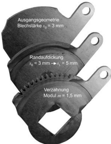
b) Inkrementelle Umformung folienförmiger Halbzeuge
