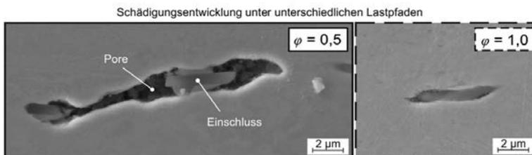
Lastpfad bei unterschiedlichen Umformgraden und resultierende Schädigungsentwicklung
