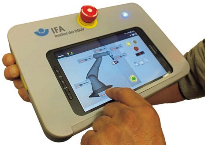
Die IFA-Rahmenkonstruktion, die beliebige Tablets aufnehmen kann und die sicherheitsrelevanten Daten selbst erzeugt.
