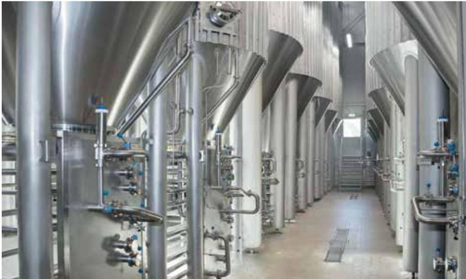
**Moderne Brauanlage** Vorhandene Anlagen wurden bei der Stadtbrauerei Spalt mit 25 zylindrokönischen, kühlbaren und isolierten Tanks verschiedener Größen kombiniert. Das neue Konzept stammt von Wellmann Engineering aus Halle.
