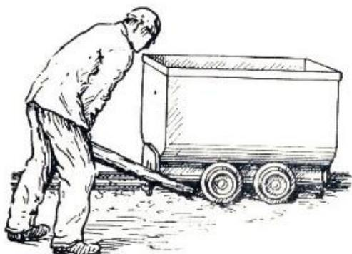
Vor dem Eingleisen den Wagen mit beiden Rädern an die Schienen heranrücken.
