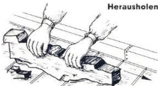
Die Stücke werden parallel zum Rand zurückgeschoben und an diesen herangekantet. Dann wird das Voraufende soweit wie möglich über den Rand gehoben. Eine Hand faßt am Hinterende nach und hebt das Bergestück auf den Rand.
