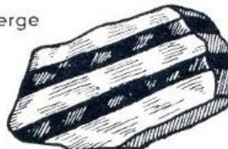
Durchwachsene Kohle wird am Ende des Bandes herausgenommen, im Brecher gebrochen und kommt mit dem Kohlenklein in die Wäsche. Nur Stücke mit überwiegend Kohle sind zu verwerten, sonst wird die Wäsche überlastet.
