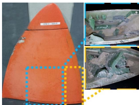
Abbildung 18: HRW01; blau: Typ 10 Schaden; orange: unsaubere Verklebung an der leading edge
