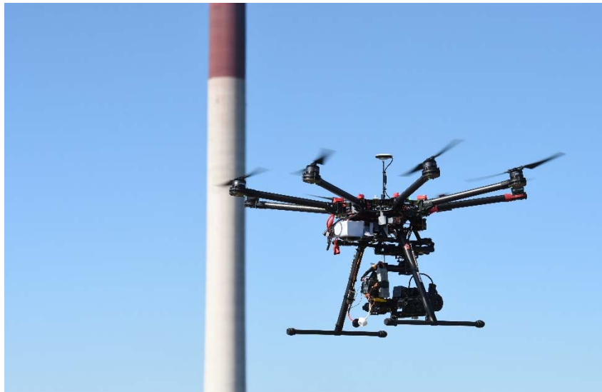
Abbildung 56: UAV mit Messgeräten und Datenübertragungstechnik im Einsatz
