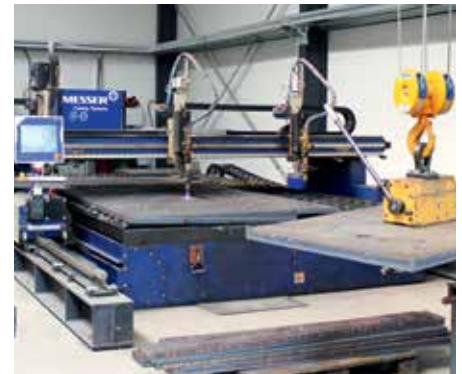
Industriebetrieb Per CNC-Brennschneidmaschine (Foto) und zwei Laserschneidanlagen werden Bleche von 0,5-600 mm Stärke zugeschnitten. Die WIB GmbH bearbeitet Aufträge mit Stückzahlen von 1 bis 10.000.
