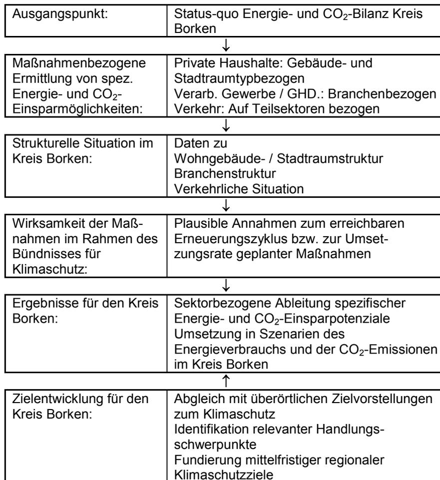
Abb. 30: Methodik der sektorbezogenen Energie- und CO<sub>2</sub>-Potenzialanalysen für den Kreis Borken
