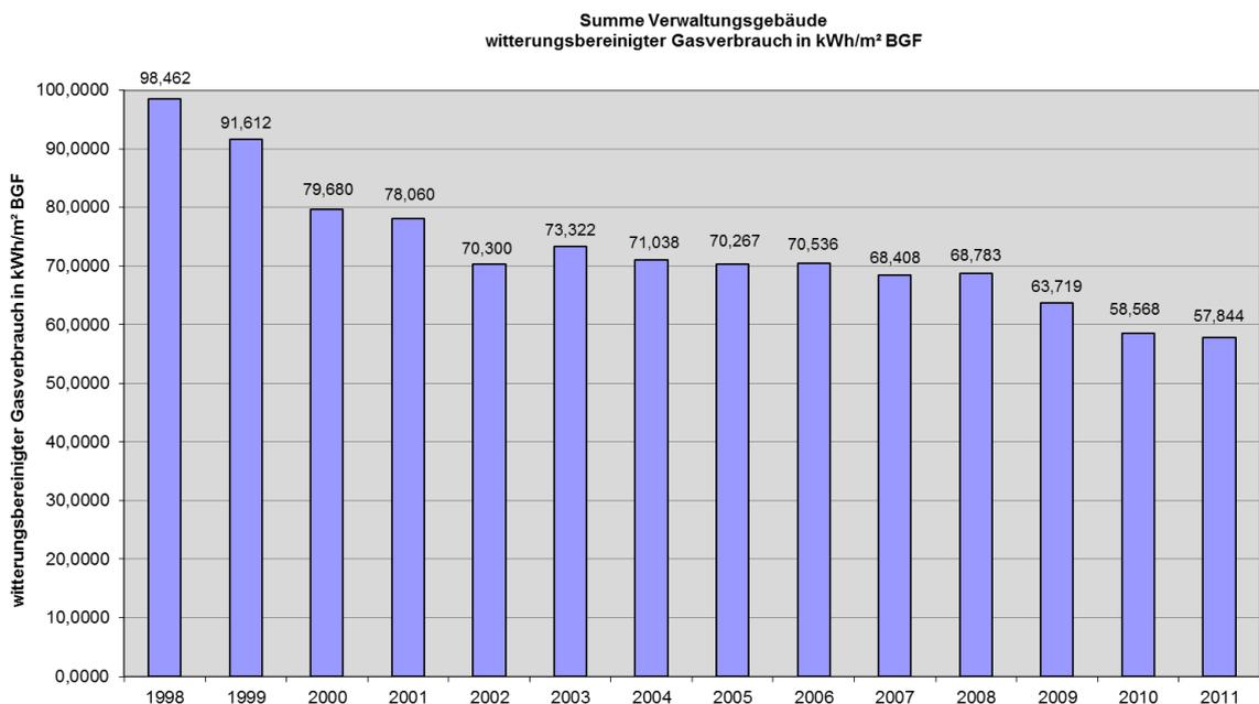
Die deutliche Reduzierung beim Gasverbrauch der Verwaltungsgebäude ist im Wesentlichen auf den deutlich gesunkenen Gasverbrauch im Kreishaus in Gütersloh zurückzuführen, der sich gegenüber dem Jahr 1998 fast halbiert hat. Diese Verbrauchsreduzierung wurde vorrangig durch eine Optimierung der Heizungssteuerung erzielt.
