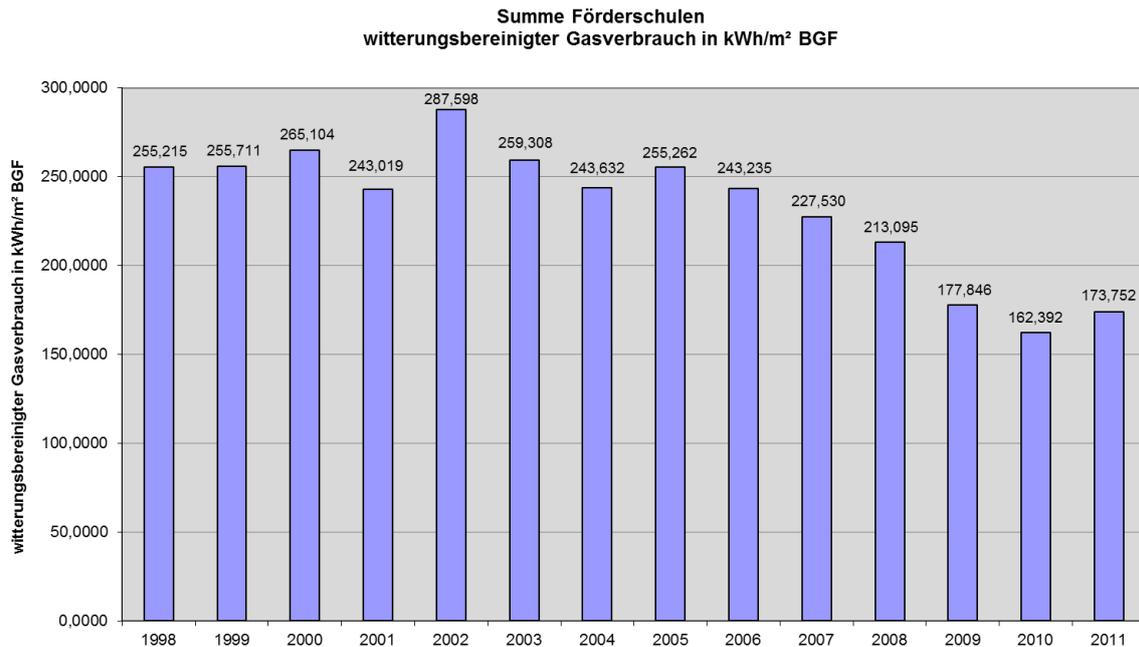
Dieser resultiert vorrangig aus der Gasverbrauchsreduzierung pro m<sup>2</sup> BGF in der Regenbogenschule. Dies ist auf Wärmedämmmaßnahmen und die Erneuerung der Heizungsanlage im Jahr 2008 zurückzuführen.
