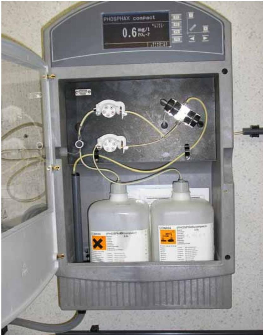
■ PO<sub>4</sub>-P Messgerät
