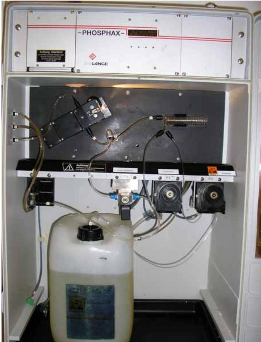
■  $\text{PO}_4\text{-P}$  Messgerät
