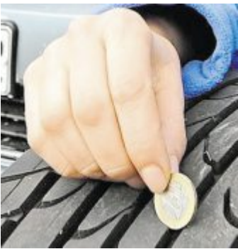
Mit einer Münze lässt sich die Profiltiefe kontrollieren. Foto: dpp-AutoReporter
