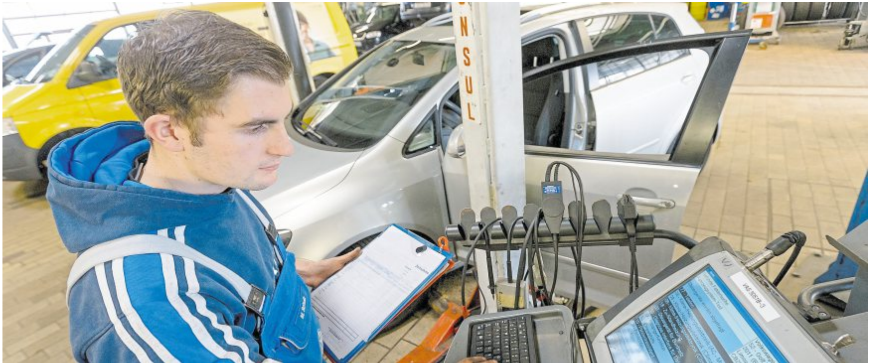
Moderne Zeiten: Bei der Inspektion greifen die Werkstätten auf elektronische Diagnosesysteme zurück.
