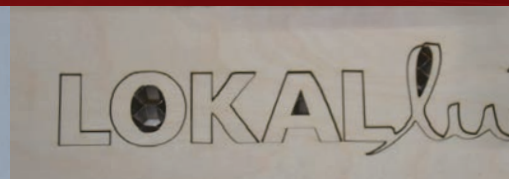
Von der Computergrafik zum fertigen Produkt: Das Lasersystem arbeitet wie ein Drucker und schneidet das Lokallust-Logo
