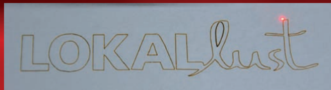
Von der Computergrafik zum fertigen Produkt: Das Lasersystem arbeitet wie ein Drucker und schneidet das Lokallust-Logo
