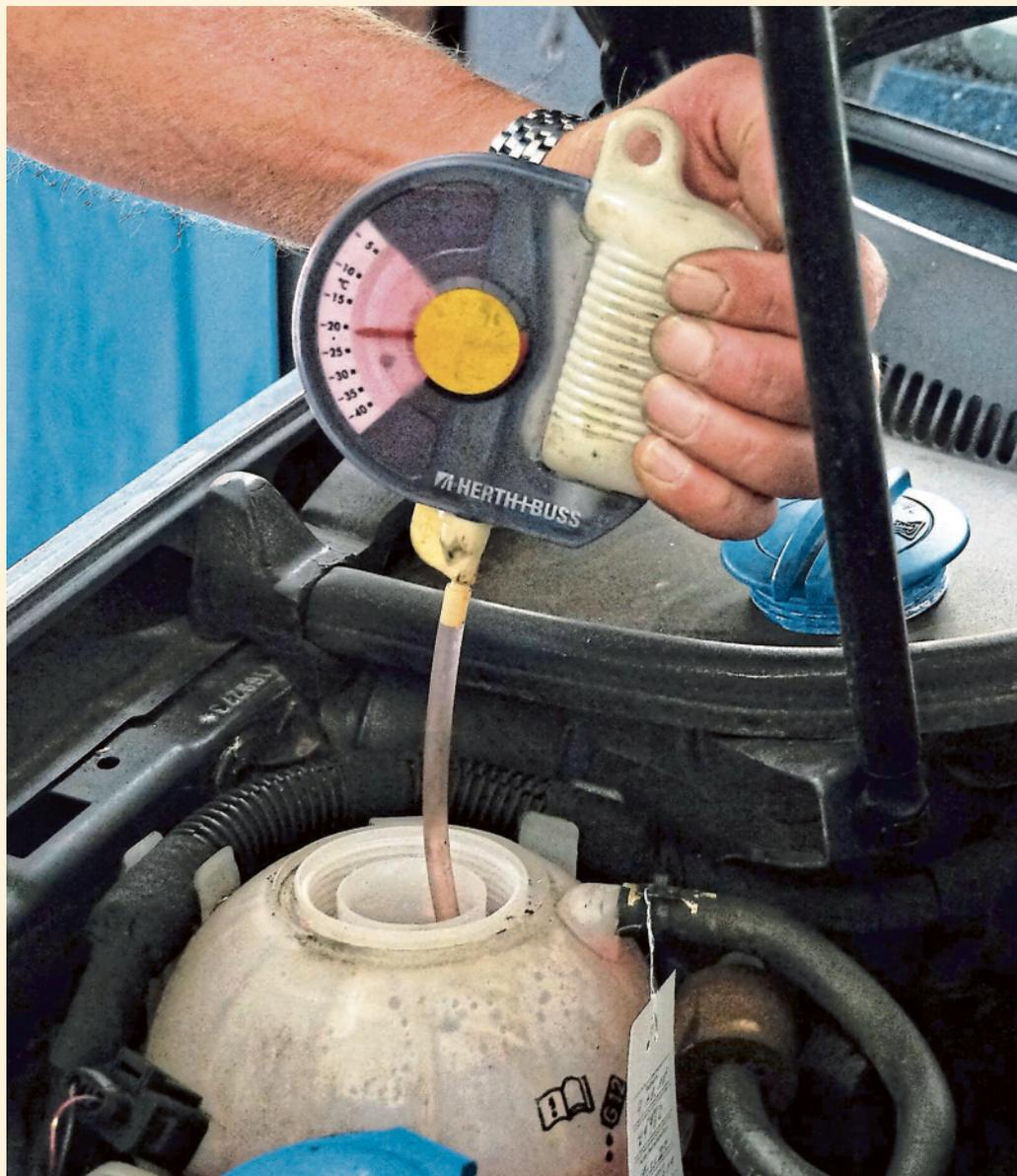
**Frostschutz prüfen:** Mindestens bis minus 25 Grad sollte dieser reichen, damit der Motor nicht einfriert. Das Messgerät hier zeigt: alles ok.
