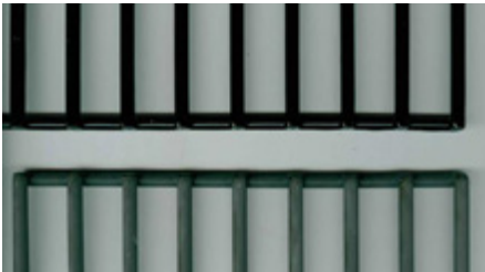
Abb. 3: Grillroste schwarz (oben Original, unten nach der Prüfung)
