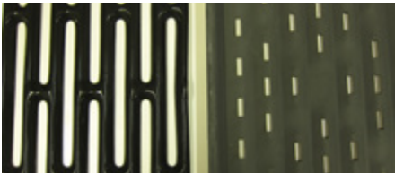
Abb. 4: Grillrost – Grillschale (links Original, rechts nach der Prüfung)
