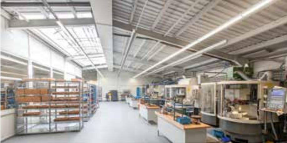
Lüftung durch Lichtkuppeln – Wärme durch Deckenstrahlheizung
