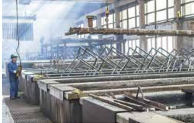
Beim Feuerverzinken bildet sich eine Legierungsschicht, die Metalle vor Korrosion schützt
