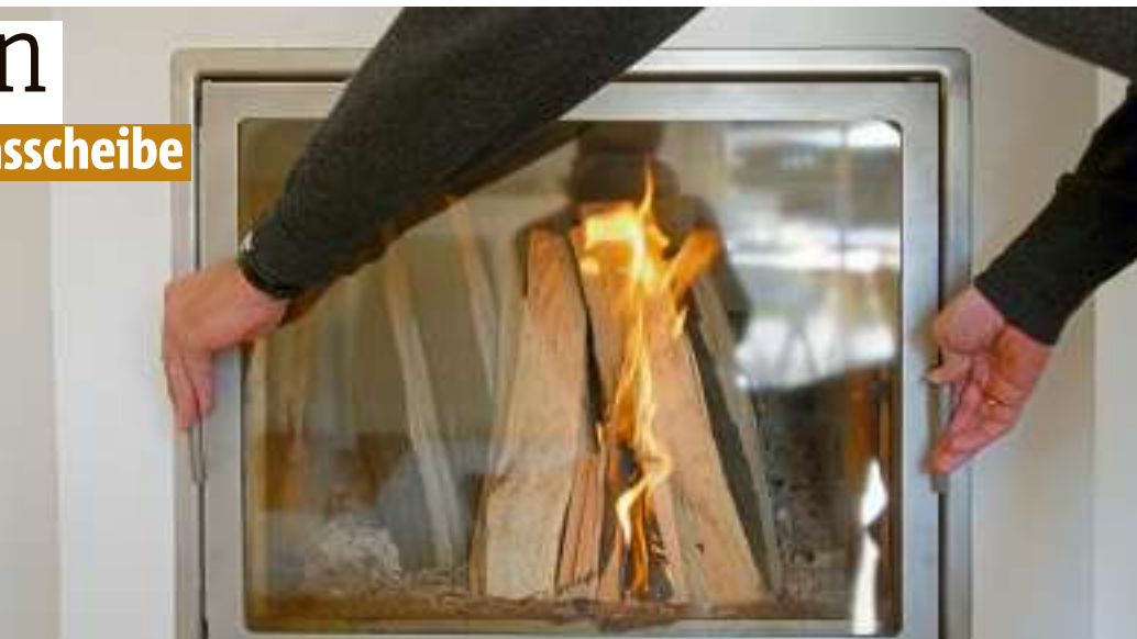
An der Scheibe zum Feuerraum des Ofens kann man erkennen, ob zu viel Holz eingefüllt wurde. An ihr würde sich dann Ruß ablagern. Foto: dpa
