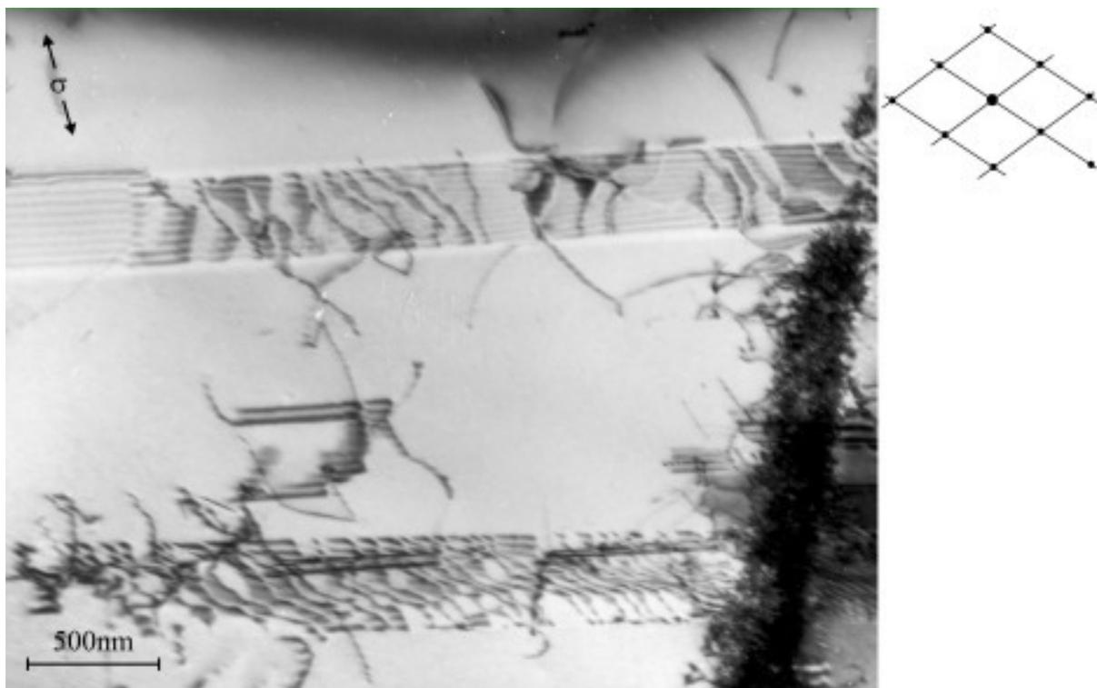
Bild 6.12: Parallel angeordnete Gleitebenen, planare Versetzungsstrukturen und Stapelfehler,  $\overline{g}_\gamma = \{111\}$ ,  $\overline{Z}A_\gamma = \langle 110 \rangle$ .
