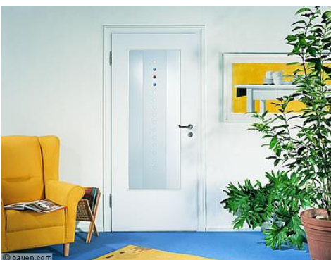
Bild 29: kontrastarme Gestaltung: Weiße Tür vor weißer Wand und silberner Türgriff vor weißer Tür, keine farbliche Abgrenzung zwischen Tür und Wand und Türgriff und Tür.
