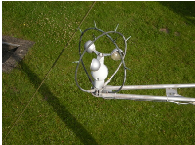
Abbildung 15: Windmast, im Hintergrund die Wetterhütte (links), Kontaktanemometer am Windmast (rechts)
