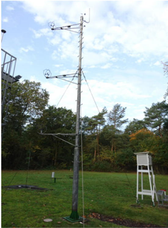
Abbildung 15: Windmast, im Hintergrund die Wetterhütte (links), Kontaktanemometer am Windmast (rechts)
