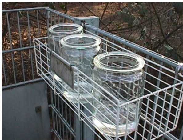
Abbildung 4: Sammelgläser zur Ermittlung der Gesamt- deposition von PCDD/F und PCB (Foto: LANUV)
