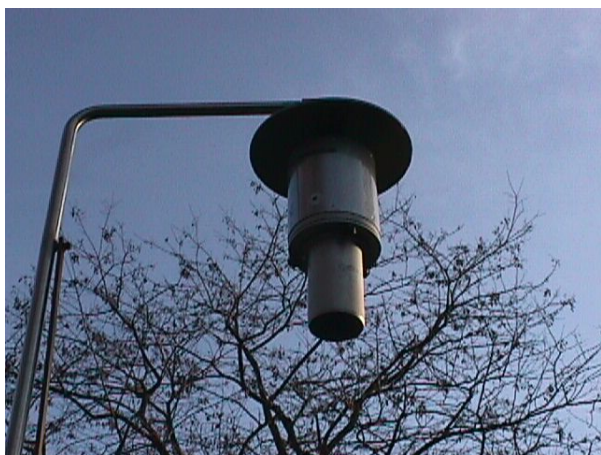
Abbildung 3: Probenahmekopf zum Sammeln von PCDD/F und PCB aus der Umgebungsluft (Foto: LANUV)
