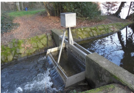
Wasserstandsmessgerät, nicht als Bauwerk zu erheben
