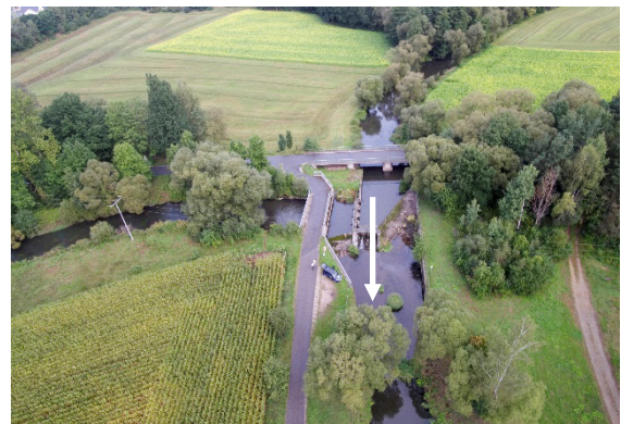
Ausleitung, Ausleitungsstrecke in Pfeilrichtung
