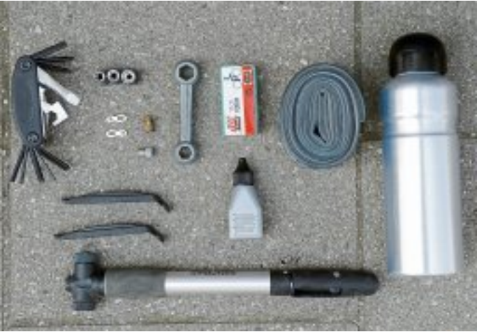
Auf längeren Touren sollte neben dem Ersatzschlauch auch das Flickzeug ins Gepäck wandern. Pumpe, Reifenheber und Multitool sind immer ratsam. Foto: dpa/Tobias Hase
