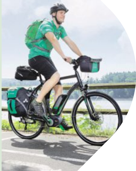
KETTLER TRAVELLER E SPORT 10 Bosch Mittelmotor 500 Wh Akku Scheibenbremsen
