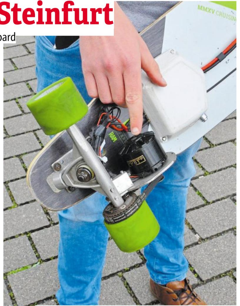
Die Halterung und die Anschlüsse für den Motor baute Vincent Fartmann sich selbst – zum Teil mit eigens angefertigten Formen aus dem 3D-Drucker. Foto: FH Steinfurt
