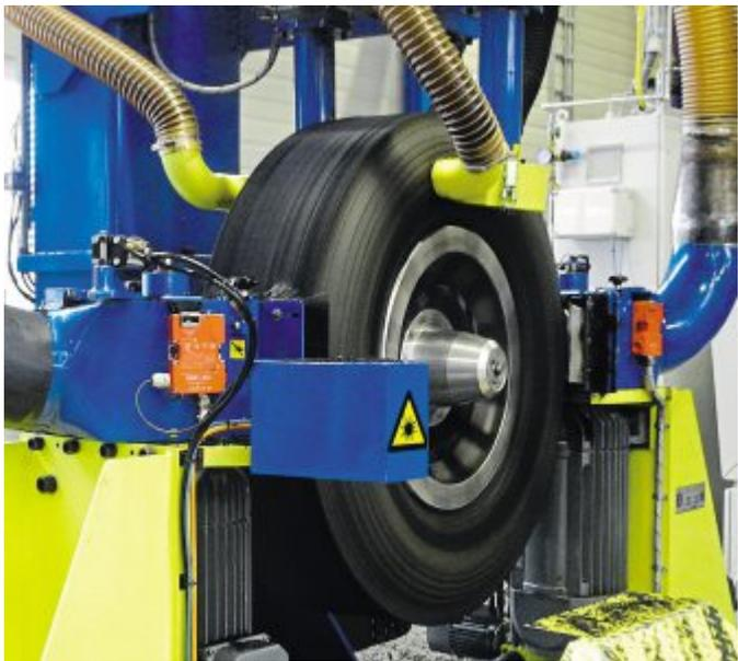
**Geburt eines runderneuertem Lkw-Reifens: Diese Maschine bringt das neue Profil auf.**
