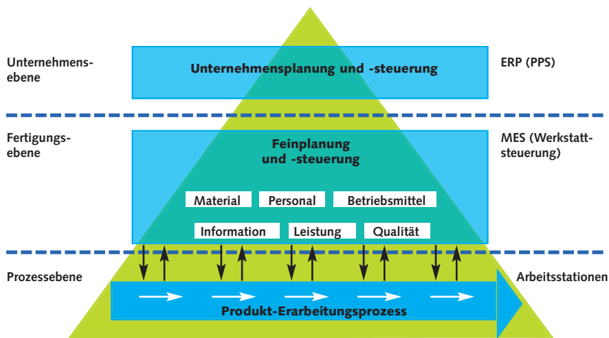
Abb. 02: MES verknüpfen die Systeme zur Unternehmensplanung mit den Arbeitsstationen der Produktherstellung. Quelle: TBS NRW
