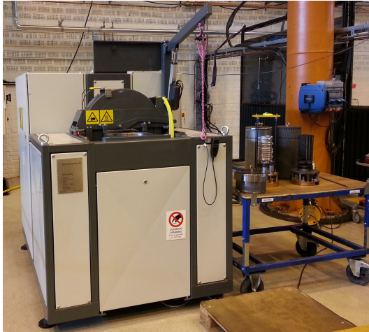
Abbildung B. 22.: HIP-Anlage QIH9 der Firma Quintus
