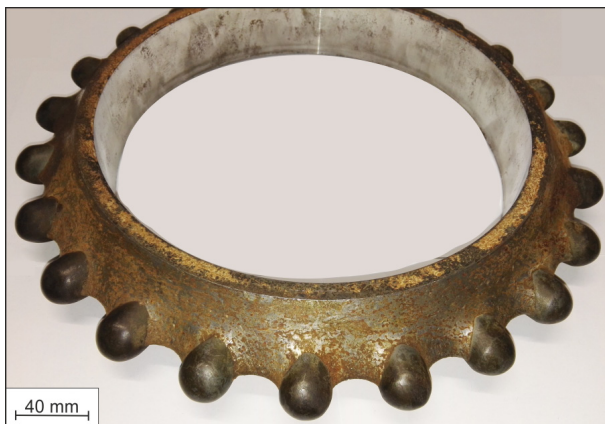
Abbildung B.17.: Verschlossener Warzenring, bei dem die Hartmetalleinsätze durch den verstärkten Abtrag des Substrats freigelegt wurden.
