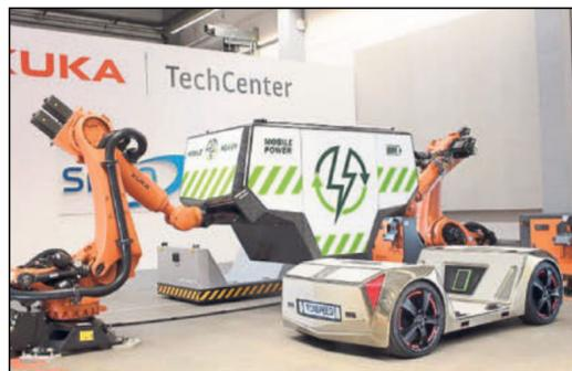
**Und so funktioniert's:** Je nach Anwendungsfall lässt sich bei diesem Konzept des Schweizer Frank Rinderknecht mit Roboterarmen der Aufbau wechseln.
