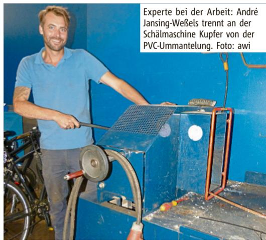
Experte bei der Arbeit: André Jansing-Weßels trennt an der Schälmaschine Kupfer von der PVC-Ummantelung. Foto: awi
