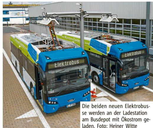
Die beiden neuen Elektrobusse werden an der Ladestation am Busdepot mit Ökostrom geladen. Foto: Heiner Witte
