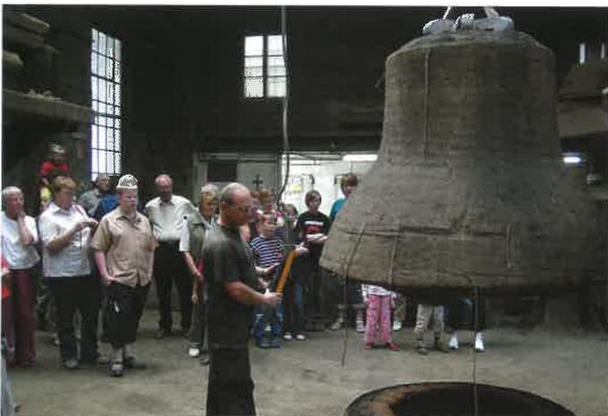
**Die Glocke wird aus der Glockengrube herausgeholt und vom Mantel befreit.**
