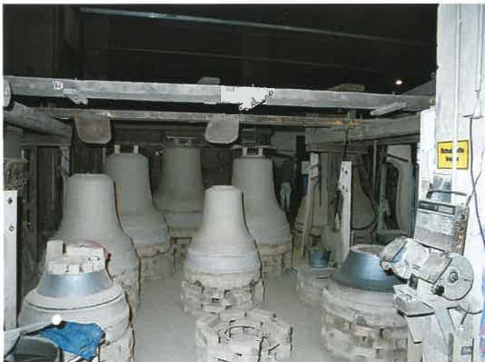
Der Glockenformer baut nun aus Lehmsteinen und -schichten den **Kern**. Er entspricht dem Inneren der Hohl der Glocke. Der zweite Formteil ist die Modell- oder „**falsche Glocke**“, deren Umfang genau der zu gießenden entspricht. Um sie zu erzeugen, wird die Schablone jetzt bis zur zweiten, äußeren Linie ausgeschnitten und auf den Kern feine Lehmstschichten aufgetragen, bis der Zwischenraum ausgefüllt ist.
