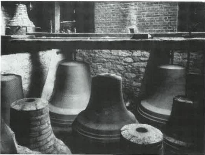
**Glockenformen in verschiedenen Fertigungsstadien:** Vorne links der aus Lehmsteinen hohl aufgemauerte Kern. Dahinter Formen, die bereits die „falsche Glocke“ tragen, auf welche nun die in Wachs vorgegossenen Inschriften und Verzierungen aufgesetzt werden können. Im Hintergrund zwei Formstände, an denen die an einer Spindel drehbare Schablone befestigt ist, der auf ein Birnbaumt Brett vom Glockengießer gezeichnete Riss der herzustellenden Glockenwand.
