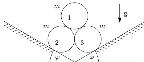
**Geg:**  $g, m, \varphi$     **Lsg:** b)  $N = \frac{3}{2 \cos \varphi} mg, K_{12} = \frac{1}{3} \sqrt{3} mg$
