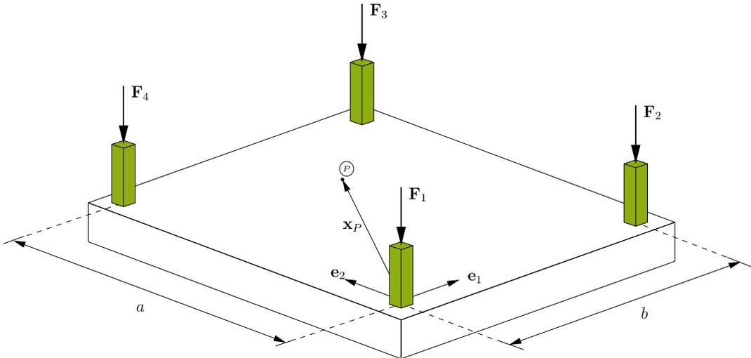
Auf eine Bodenplatte wirken über 4 Stützen die Kräfte  $\mathbf{F}_i$ ,  $i = 1, 2, 3, 4$  (alle parallel zur  $\mathbf{e}_3$ -Richtung), ein. Berechnen Sie die Resultierende  $\mathbf{R}$  der Kräftegruppe und bestimmen Sie die Koordinaten des Punktes  $\textcircled{P}$  so, dass das resultierende Moment bezüglich  $\textcircled{P}$  verschwindet ( $\mathbf{M}_P = \mathbf{0}$ ).
