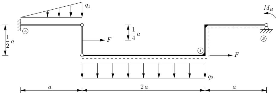
**Geg:**  $q_1, q_2, a, F, M_B$     **Lsg:**  $M_I = 2/3 (M_B + 3/4 F a + q_2 a^2)$
