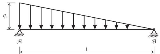
**Geg:**  $l = 5 \text{ m}$ ,  $q_0 = 7 \text{ kN/m}$
