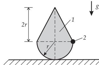
**Geg:**  $r, G_1 = G, G_2 = G/4$     **Lsg:**  $\varphi = -53,25^\circ$  (instabiles GG)
