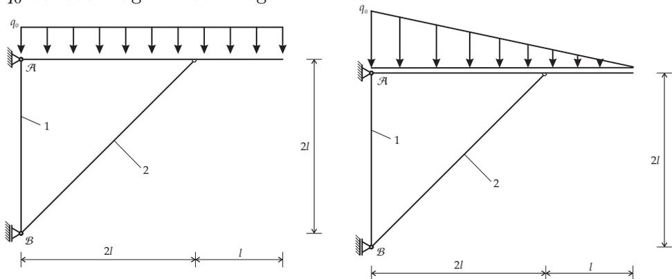
Bestimmen Sie alle Auflager- und Stabkräfte für a) die konstante sowie b) die lineare Streckenlast mit dem Maximalwert  $q_0$ .
