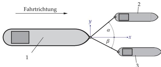
Berechnen Sie die sich während des Transports einstellenden Winkel  $\alpha$  und  $\beta$  der Zugseile.
