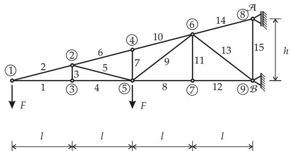
Berechnen Sie alle Stabkräfte sowie die vom Kragarm auf den Hauptmast übertragenen Kräfte.
