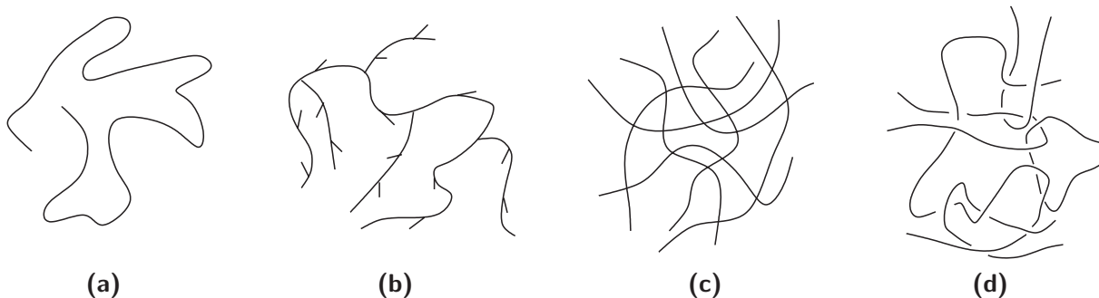
Abbildung 2.1. Schematische Darstellung: (a) lineare, (b) verzweigte, (c) vernetzte und (d) verschlaufte Makromoleküle bzw. Ketten
