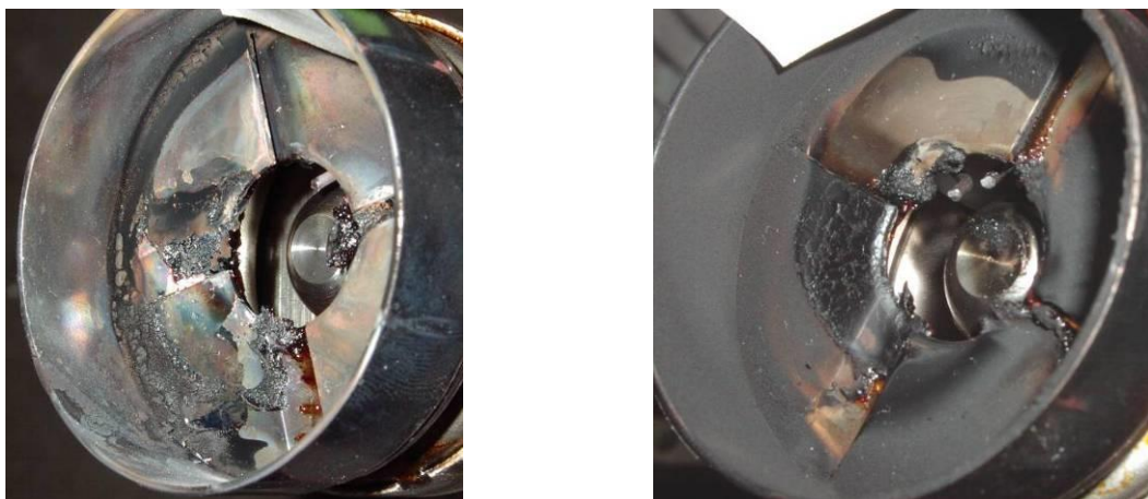
Abbildung 1: Ablagerungsbildung auf der Stauscheibe eines Gelbbrenners nach dem Betrieb mit 20 % FAME-HEL S-arm; links - mit Additiv, rechts - ohne Additiv [Mardorf 04]
