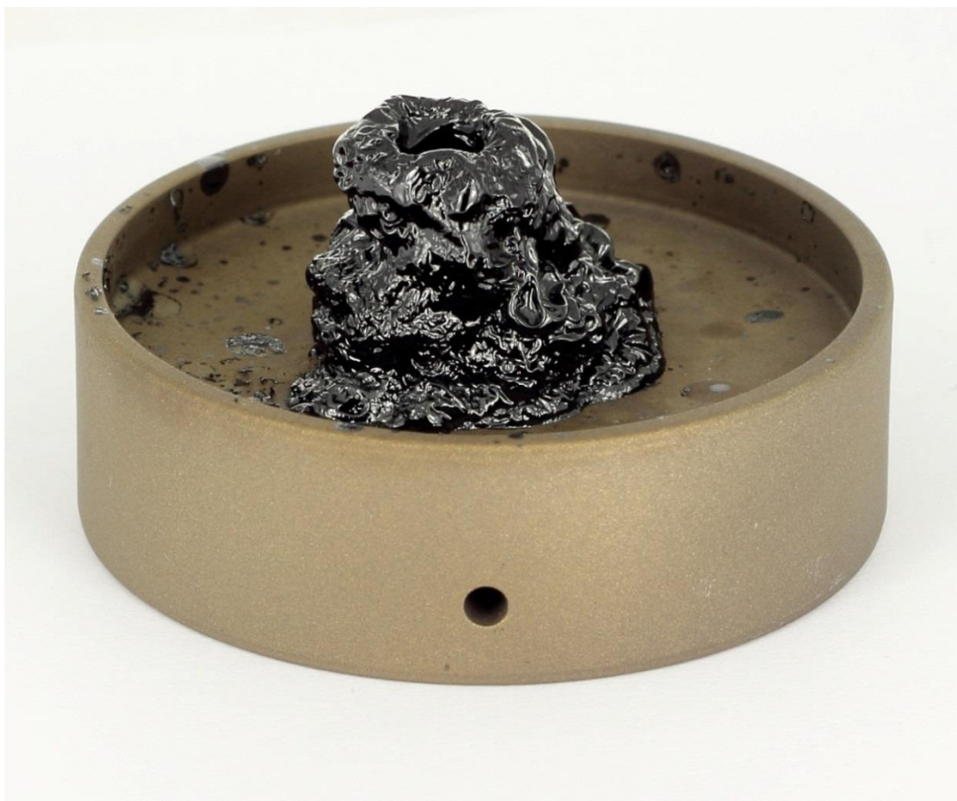
Abbildung 70: Rückstände eines kupfergealterten FAME-Blends nach dessen Verdampfung bei 350 °C auf einem Standardprobenkörper (f11.0, 1/10 s, ISO 100) [Ei- den 14]
