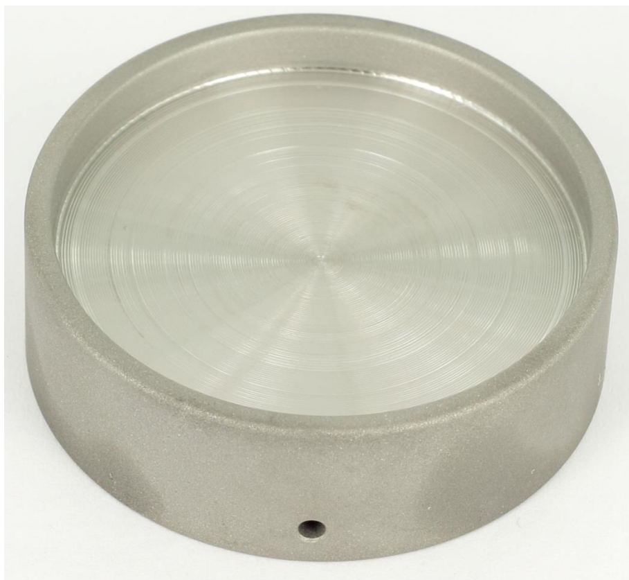
Abbildung 77: Probenkörper mit Frässtruktur (f11.0, 1/10 s, ISO 100)
