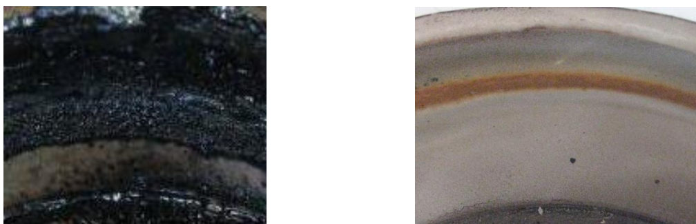
Abbildung 2: Verdampferoberfläche eines Vormischbrenners nach 100 h Betrieb mit HEL S-arm + 5 % FAME (links) [Rheinb. 09] und nach Anhebung der Verdampfertemperatur mit HEL S-arm + 10 % FAME (rechts) [Jaschi. 12]
