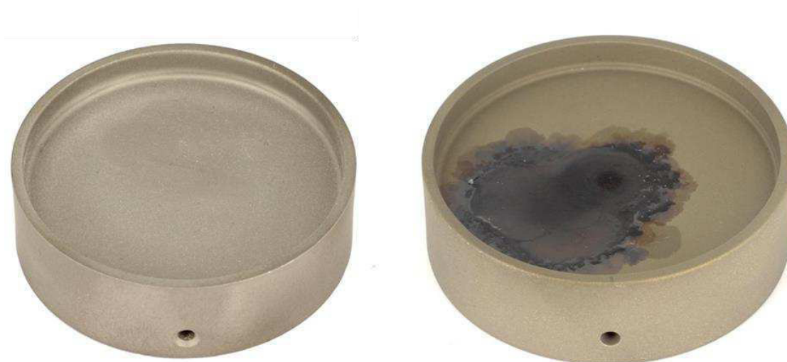
Abbildung 47: Tiegel vor (links) und nach (rechts) einem Versuch (f11.0, 1/10 s, ISO 100)
