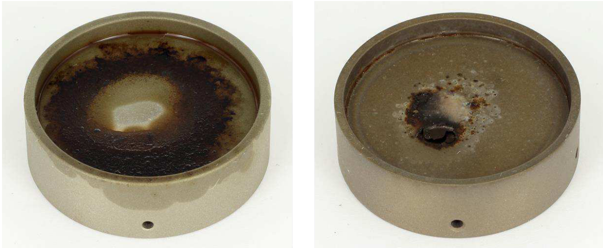
Abbildung 62: Ablagerungen des Fraktionsgemischs bei 200 °C (links) und bei 350 °C (rechts) Oberflächentemperatur (f11.0, 1/10 s, ISO 100)
