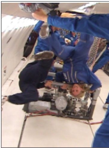
Rock'n'Roll im All: Bei einem Parabelflug steigt die Maschine erst in einem Winkel von 45 Grad. Auf einer Höhe von 7000 bis 8500 Metern werden die Triebwerke gedrosselt, die Schwerkraft nimmt ab. 22 Sekunden dauert die Schwerelosigkeit, bevor der Pilot den Airbus A 300 wieder abfährt und der Tanz von vorne beginnt.
