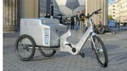
Das Cargobike der Masterflex AG, hier im Einsatz bei der Telekom, wird mit Brennstoffzellen angetrieben.
