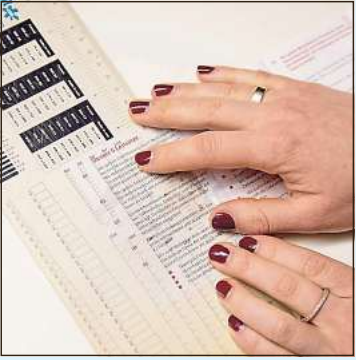
Mit einem Typometer werden Schriftgrade und Zeilenlängen gemessen. Bild: dpa
