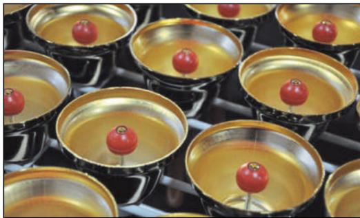
Die Handglocken in ihrer Halterung: Inmitten der Klangkörper sind die Schlegel aus roter Gummikugel und Spirale zu erkennen.
