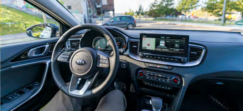
10,25-Zoll-Navigation mit Bluetooth-Mehrfachverbindungen und Split-Screen-Funktion.
