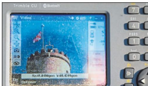
Mit dem Tachymeter wird die obere Kante einer Zinne auf der Spitze des Turms angepeilt.
