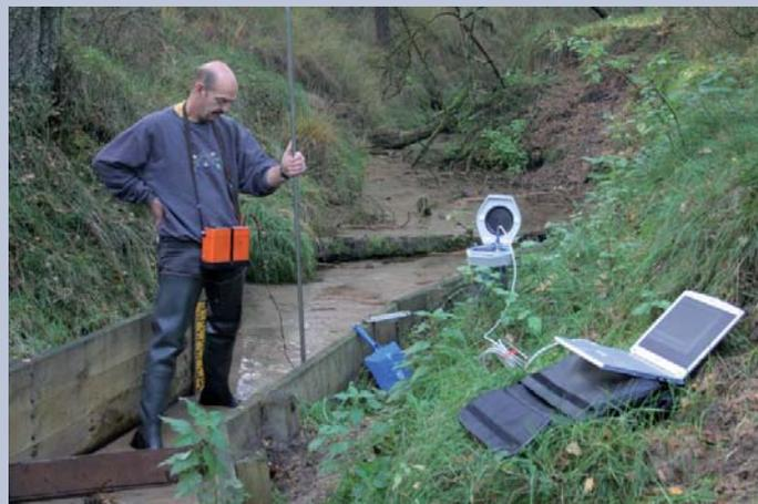
Bild 1: Abflussmessung am Pegel Sennelager3/ Grimkequelle
