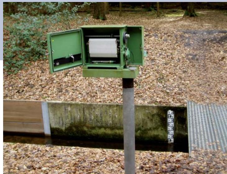
Bild 3: Pegel Schloss Holte / Ölbach nach dem Umbau
