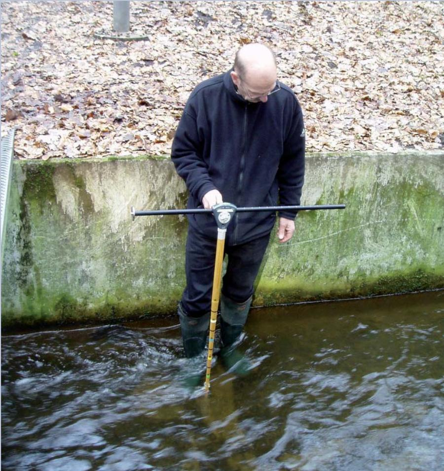
Bild 4: Abflussmessung mit dem Tauchstab nach Jens
