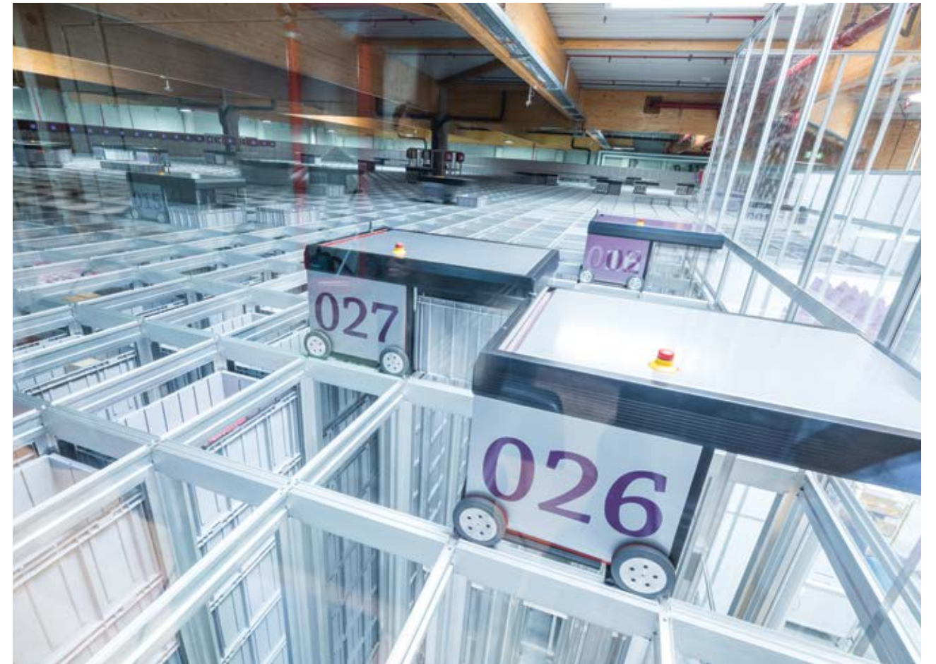
Die Roboter auf der oberen Etage des Auto-Stores verbrauchen nicht mehr Energie als zwei durchschnittliche Haushaltsstaubsauger – und bedeuten für die „Picker“, die bei Weiling die täglichen Warenlieferungen kommissionieren, eine enorme Arbeitserleichterung, berichtet Geschäftsführer Dr. Peter Meyer.
