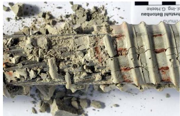
Bild 9: Entnommenes Spannglied im Bereich des Betonrisses, hier: Versuch SB01
