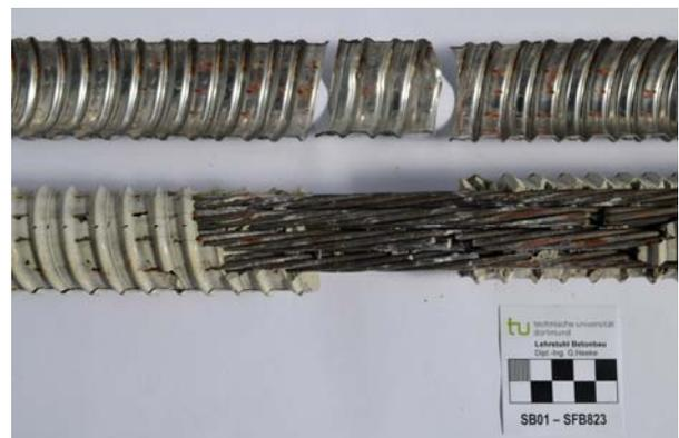
Bild 10: freigelegte Litzen; (Versuch SB01)
